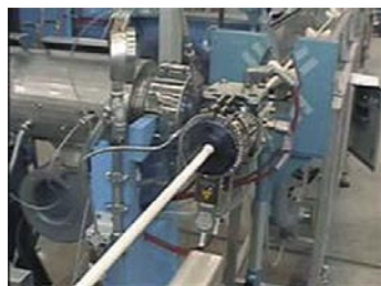
Nakładanie warstwy poliamidowej
