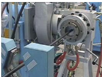
Nakładanie warstwy gumowej
