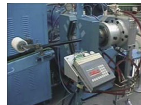
Powlekanie warstwą zewnętrzną
