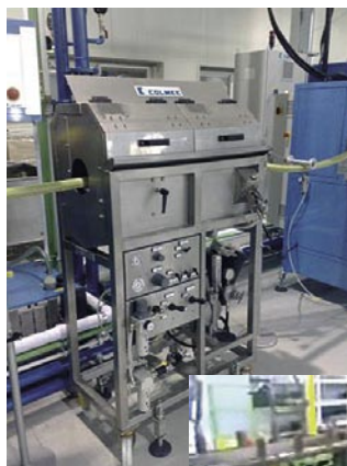
Urządzenie do napyłania silikonu
