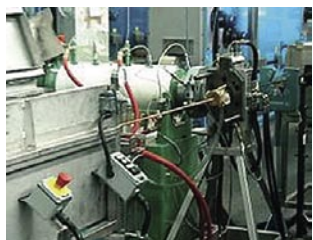
Powlekanie rdzenia elastycznego
