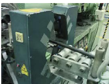
Wytłaczanie rdzenia gumowego
