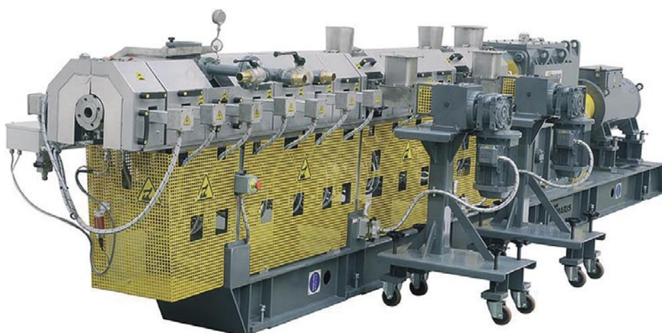
Rys. 1. Wytłaczarka do produkcji klejów Hot Melt.
